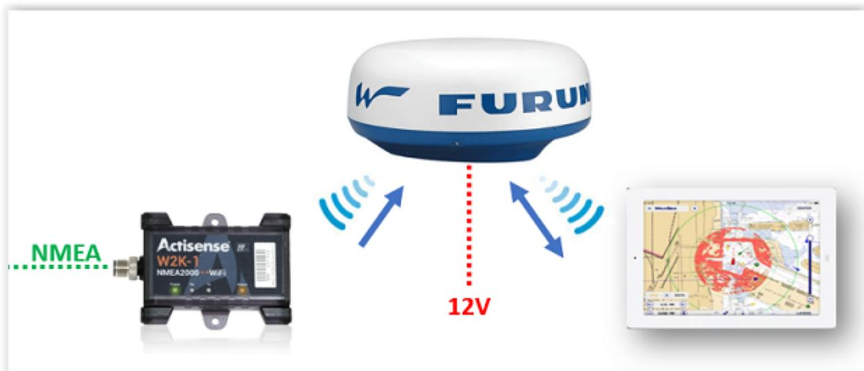
Vous devez vous assurer que la passerelle Wi-Fi que vous souhaitez utiliser est compatible avec le réseau WI-FI existant pour se connecter en Wi-Fi avec le radar DRS4W. Vous devez être capable de régler la passerelle Wi-Fi pour qu'elle se connecte au réseau DRS4W en entrant le SSID et le mot de passe du radar DRS4W.
